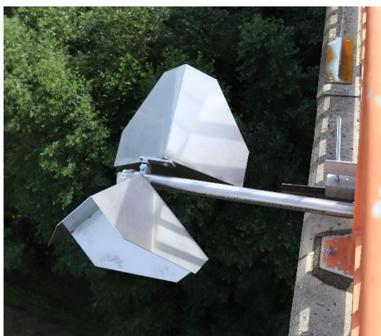
Obr. 6 : Dva koutové odražeče nasměrované na jednotlivé radary.
