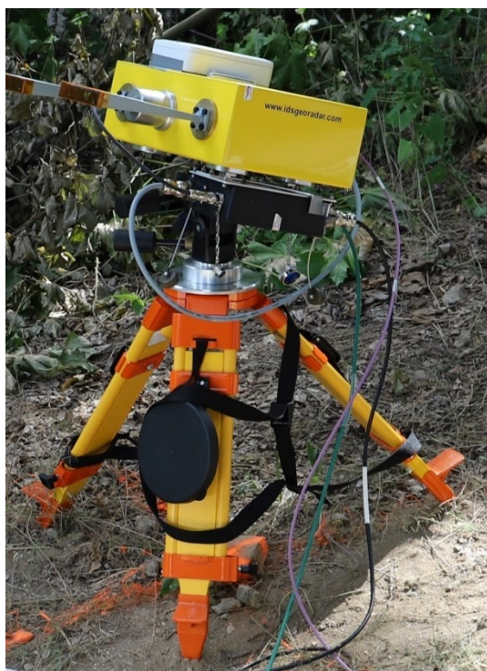
Obr. 10 : Geodetický stativ pro lepší stabilitu radaru
