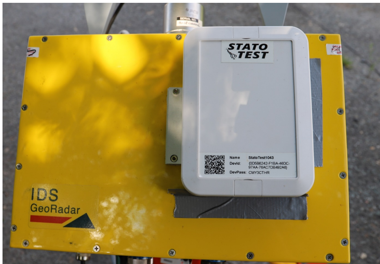
Obr. 5 – Náklonoměr umístěný na radaru
