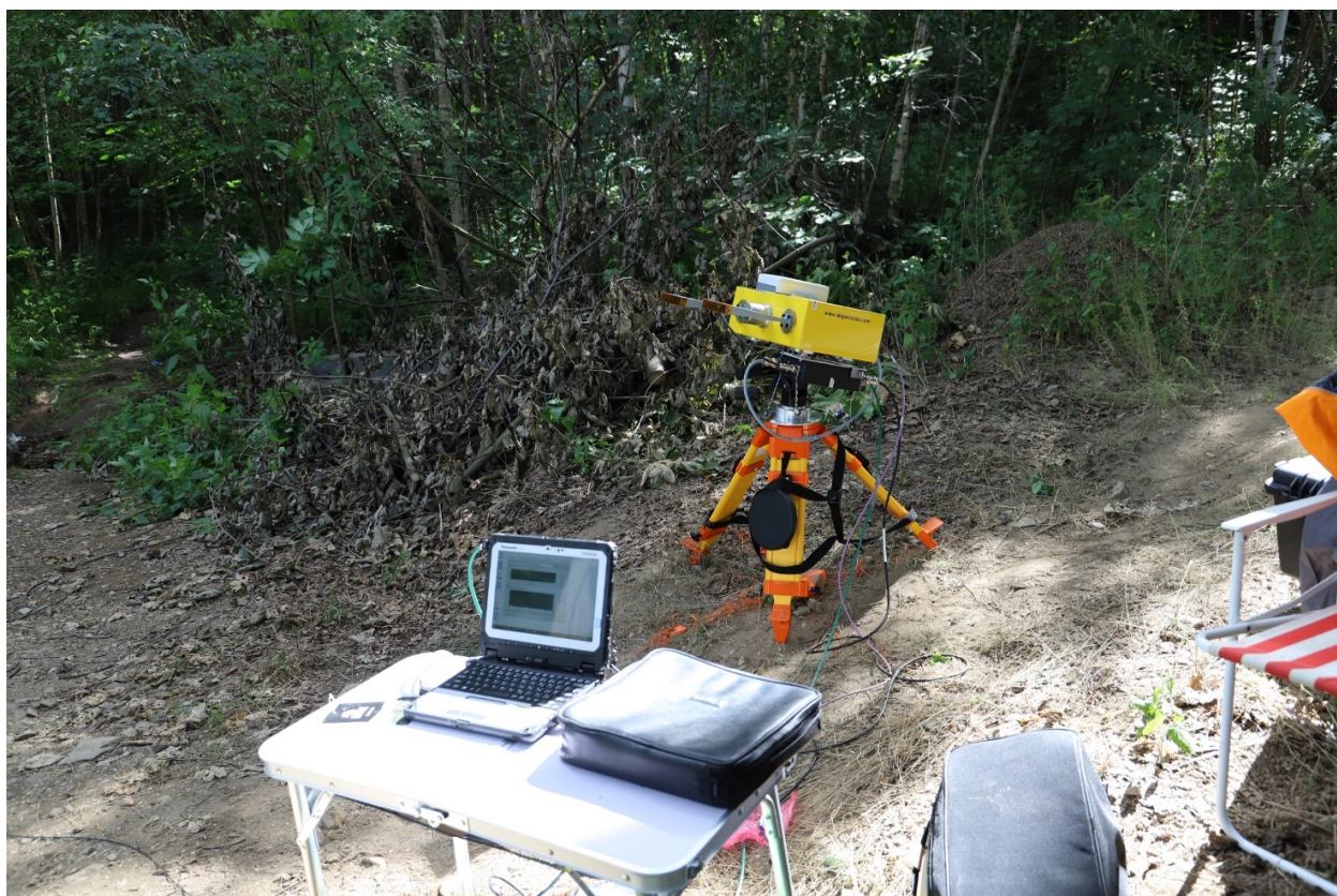
Obr. 9 – Pohled na radar R_1 vysílající měřicí signál ve směru staničení mostu
