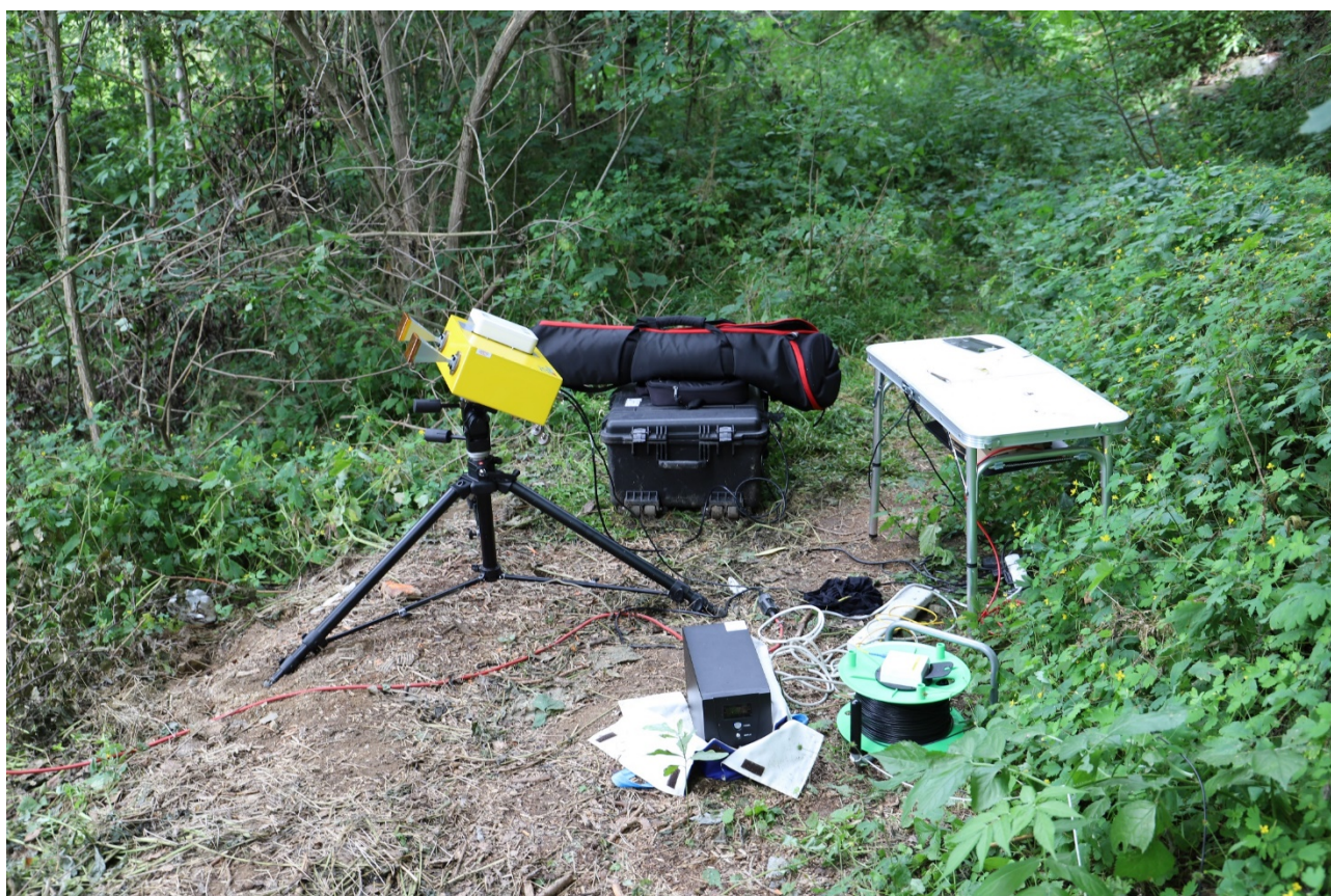
Obr. 10 – Pohled na radar R_2 vysílající měřicí signál proti směru staničení mostu
