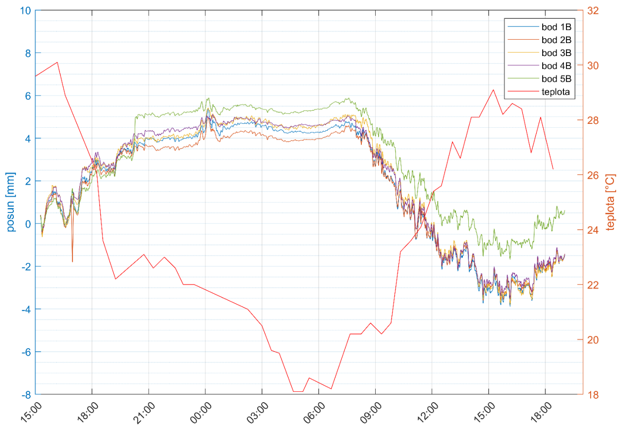
Obr. 29 – Svislé průhyby naměřené na severní straně mostovky (na levé straně při pohledu ve směru staničení mostu, respektive na vnitřní straně směrového oblouku) vypočtené kombinací měření obou radarů (pro lepší čitelnost grafu byl pro zobrazení měření použit klouzavý průměr)
