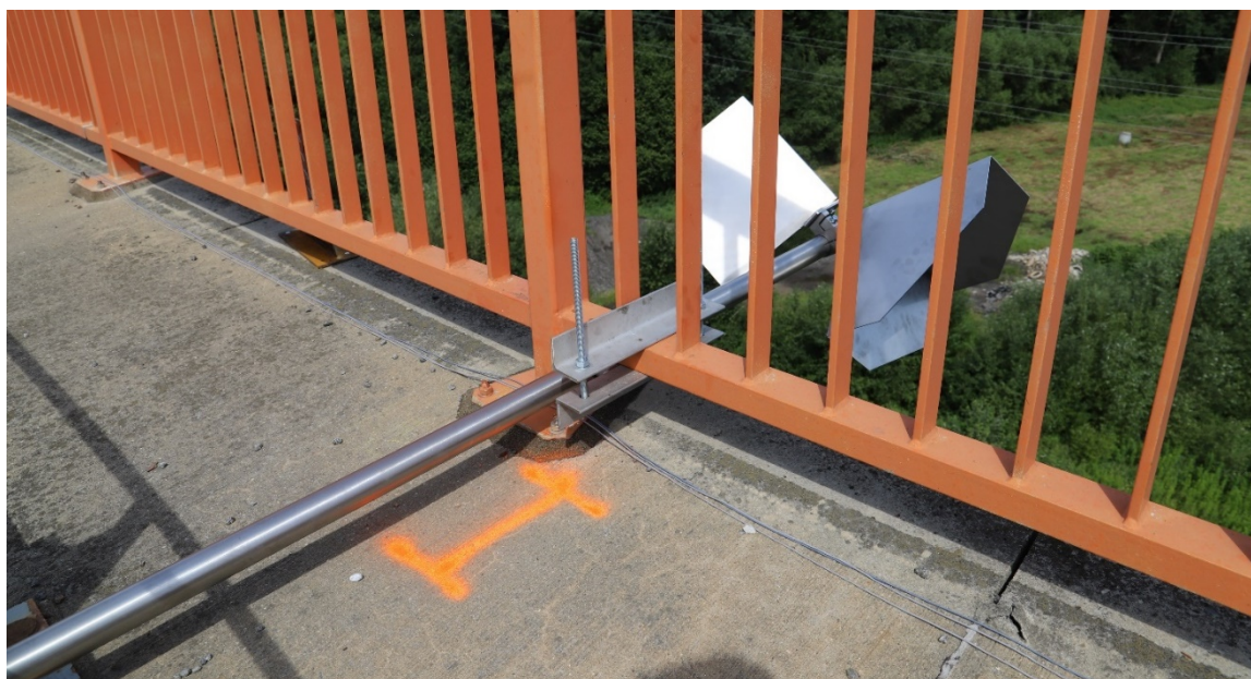
Obr. 3 – Dvojice koutových odražečů upevněných ve sledovaném bodu na vodorovné nosné konstrukci mostu
