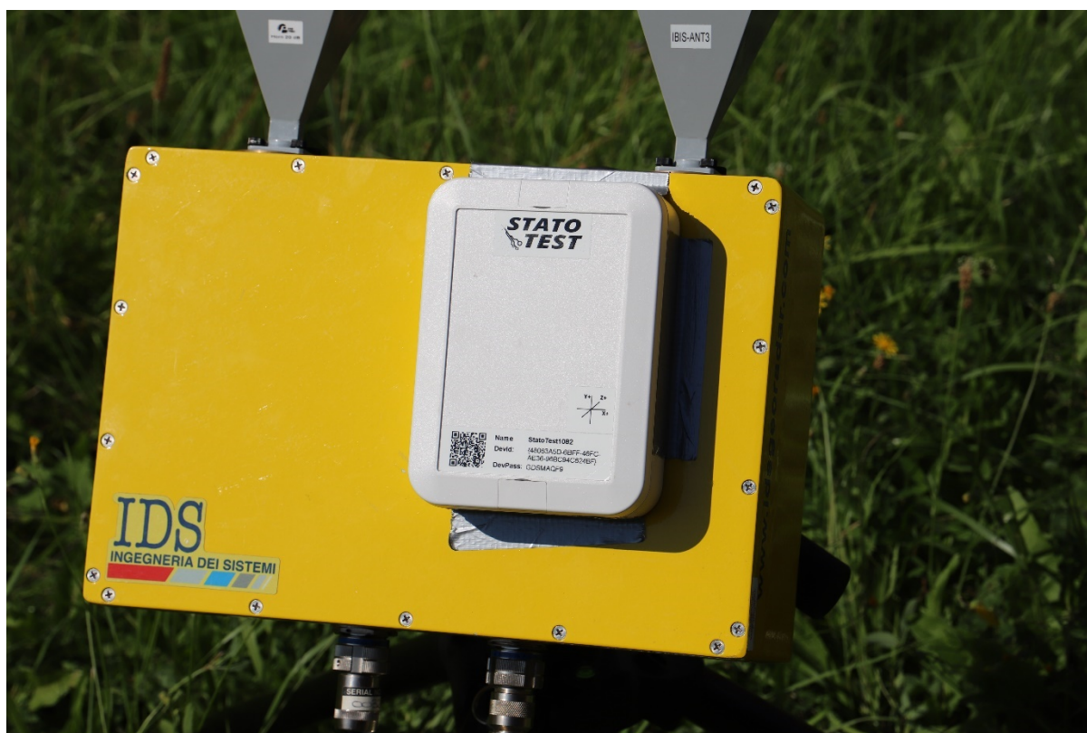
Obr. 13 : Náklonoměr připevněný k radaru
