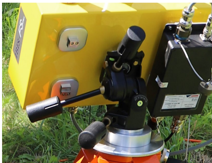
Obr. 11 : 3D hlava upevňující radar na stativu
