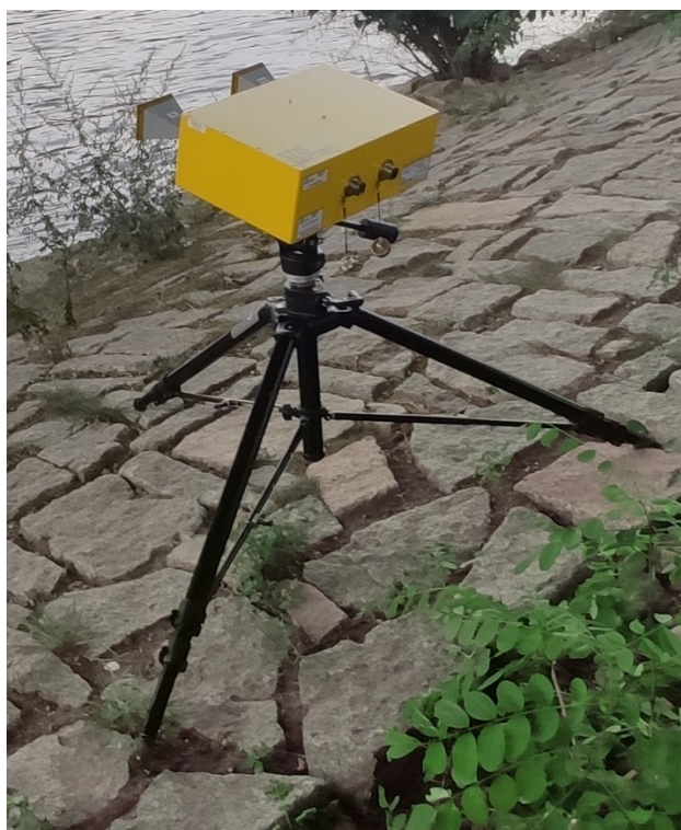
Obr. 9 : Stativ dodávaný s radarem
