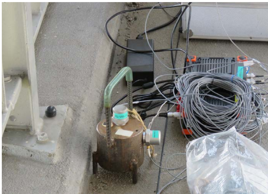
Obr. 4 – Pohled na měřicí ústřednu SIRIUS a ocelové závaží s uchycenými dvěma snímači zrychlení 8344 v bodu 32 - řez ve středu rozpětí
