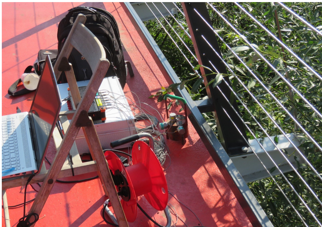
Obr. 5 – Pohled na měřicí ústřednu SIRIUS a ocelové závaží s uchycenými třemi snímači zrychlení 8344 v bodu 62 - řez s příčnickem s uchycenými závěsy č. 10 (R1 Rbin 22 a R2 Rbin 29)
